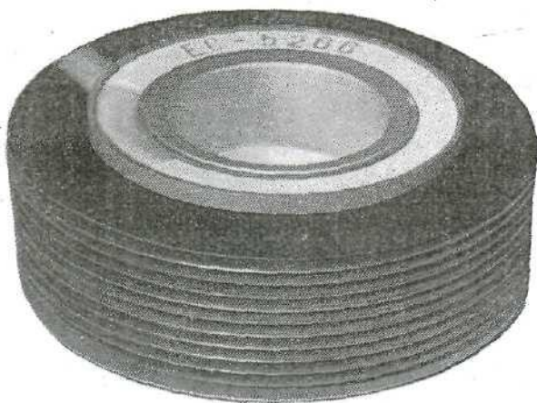
100-M-Byte-Wechselplatten EC 5266 (UdSSR)
